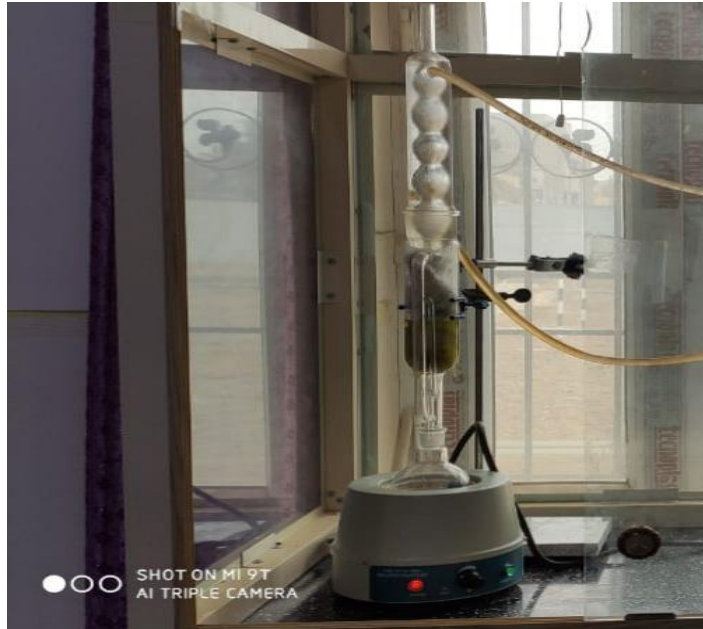
شكل (2-1) يمثل جهاز سوكسلت المستخدم في استخلاص زيت الكزبرة في المختبر
